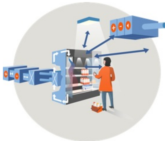
Figur 1 I en butik sker hela tiden ett utbyte av energi. Framför en kyldisk sker växelverkan genom mötet mellan det varma omgivande inneklimatet och kyldiskens kalla temperatur. Kyl- och fryssystemen är i de flesta fall direkt eller indirekt kopplat till resten av byggnadens tekniska system och installationer.
